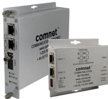
La série de convertisseurs de média CNFE200X permet de transmettre 2 entrées Ethernet sur fibre optique, avec en option du PoE+. Ces périphériques prennent en charge l'auto-négociation sur les 2 ports en 10/100 Mbps et convertissent le signal en sortie fibre optique 100 Mbps. Cette série utilise des fibres optiques multimodes ou monomodes et des connecteurs optiques SC ou ST à une ou deux fibres.
