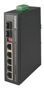
Le ComNet CNGE6FX2TX4POE est un switch PoE+ industriel à six ports. Il dispose de quatre ports RJ45 10/100/1000Base-TX plus un port combo RJ45/SFP et un port SFP 100/1000Base-FX. Les ports 1 à 4 peuvent fournir jusqu'à trente (30) watts de PoE selon la norme IEEE 802.3af/at. Il est alimenté par une alimentation externe 48-56VDC et est utilisé pour la surveillance IP, la surveillance du trafic et d'autres applications IP.
